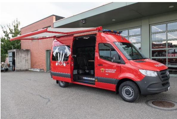
(PTF 2, welches auch als mobiler Kommandostand benutzt werden kann)
