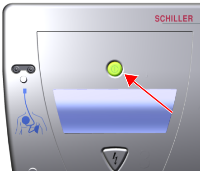
Abb. 2.1 Taste für das Ein- und Ausschalten des Geräts sowie den Start der Analyse (nur im halbautomatischen Betrieb)
